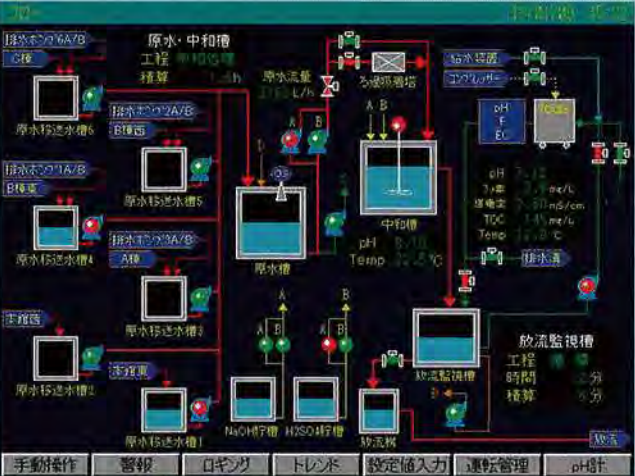
一般実験排水処理設備タッチパネル画面
