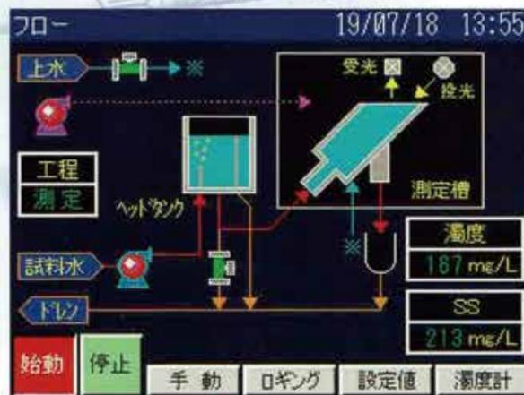
チパネルには、モニター画面、測定データロギング画面、警報履歴画面、校正操作画面など、運転管理およびメンテナンスを行う上で便利な情報を表示します。また、測定データは、USBメモリーにCSV形式で自動保存され、パソコンで容易に閲覧出来ます。
